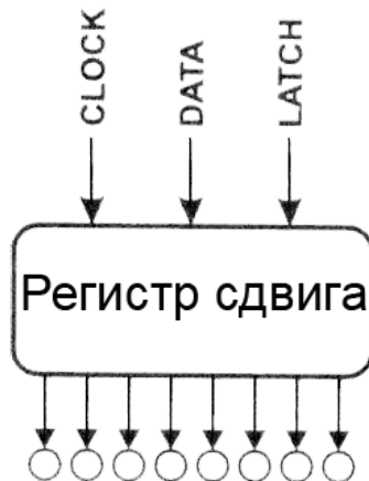
Рисунок 67. Входы и выходы регистра сдвига
